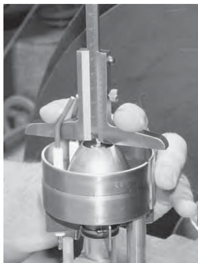
Mesure d'écart gicleur de fioul - buse à air
